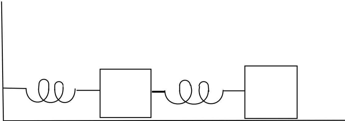
Die Massen seien beide gleich 1, die Federkonstanten seien 3 und 2. Ferner seien  $u_1$  und  $u_2$  die horizontalen Abweichungen der beiden Massen von der Ruhelage. Die Regeln der Mechanik ergeben, dass die Bewegungen des Systems durch die Lösungen des folgenden Systems von zwei Differentialgleichungen 2. Ordnung beschrieben werden:
