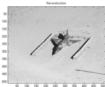
Figure: L_1 -norm regularisation \min \{ \|\mathfrak{A}\mathfrak{x} - \mathfrak{b}\|_2^2 + \alpha \|\mathfrak{x}\|_1 \}
